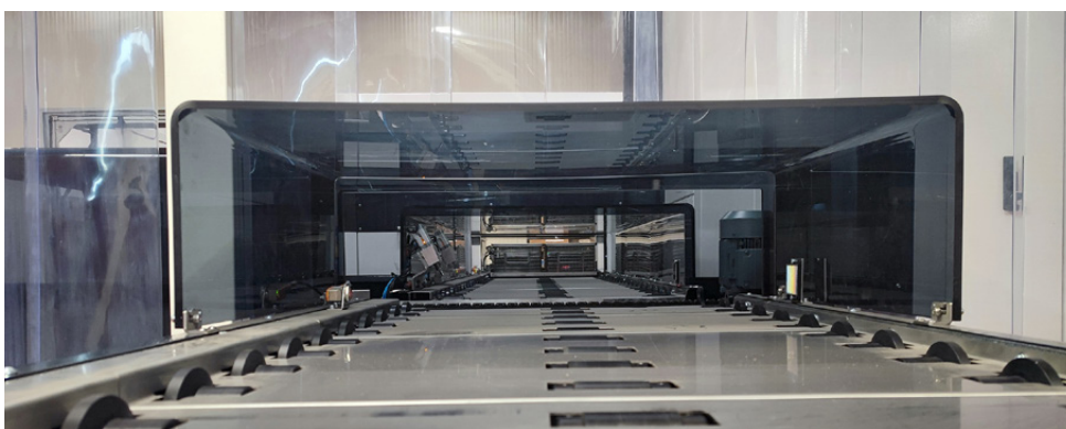
Tunnel di carico automatico dell'impianto KP.100 Hybrid: autonomia operativa e assenza di presidio continuo dell'operatore
