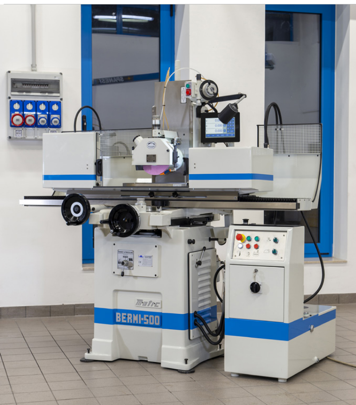
Bermi 500Matic, rettifica tangenziale a pilotaggio idraulico, riferimento della gamma per operazioni di aggiustaggio e piccole produzioni
