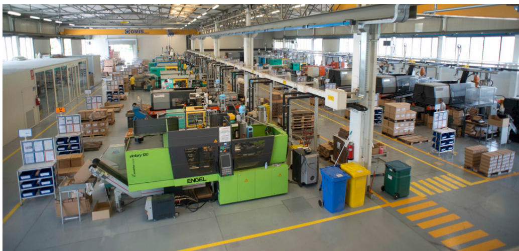
Il parco presse di Gielle Plast copre un range da 50 a 600 ton, per un totale di 35 macchine distribuite
