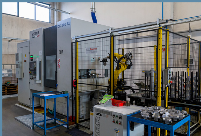
La dentatrice a creatore Comur DK 200 RL, asservita da robot, consente a Orlandi Ingranaggi di garantire continuità operativa e gestione automatizzata dei lotti produttivi
