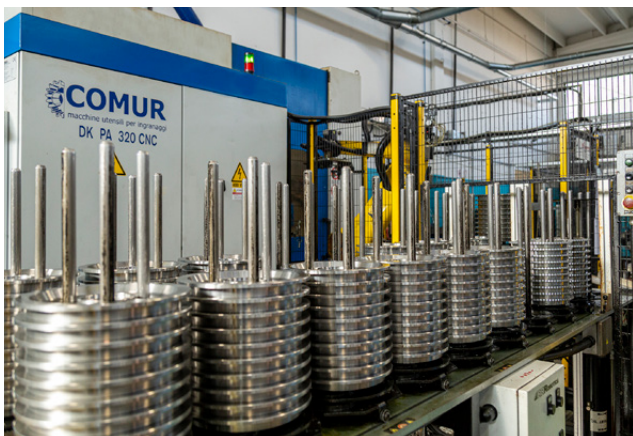
La dentatrice a creatore Comur DK PA 320 CNC installata nel reparto Orlandi Ingranaggi, integrata con automazione di carico, è dedicata alla produzione continuativa di componenti dentati in serie
