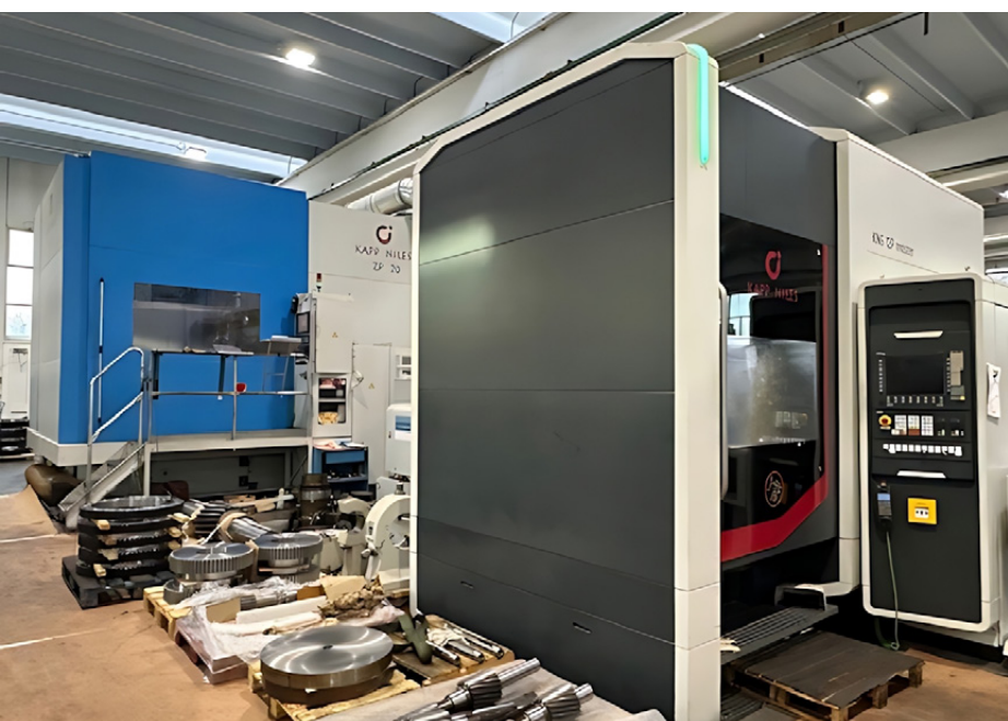
Vista del reparto di rettifica dei componenti interni ed esterni degli ingranaggi di Ceba Ingranaggi, dotato di un'ampia gamma di rettificatrici per profili Kapp Niles
