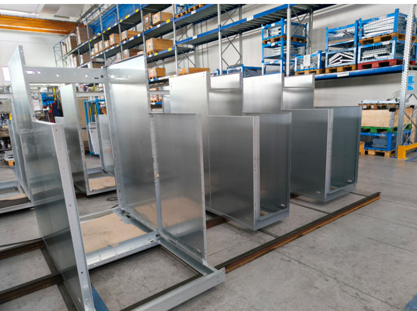
Dettaglio strutture di carpenteria per quadri elettrici in fase di assemblaggio, con gestione di lotti differenziati
