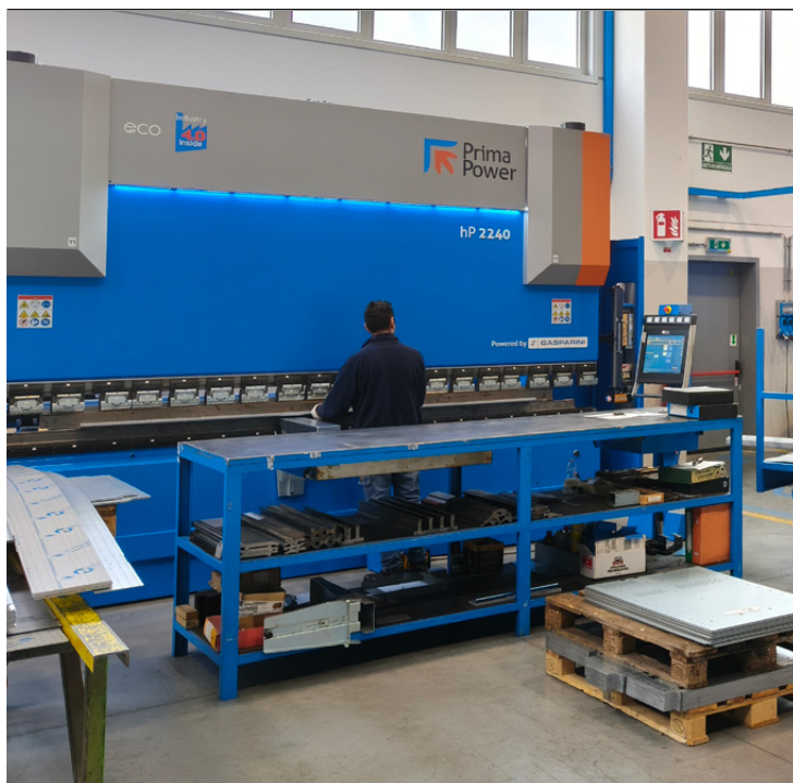
Nel reparto di piegatura di Casagrande Elettrocostruzioni, le pieghatrici eP 0520 e hP 2240 affiancano la pannellatrice nella gestione di lotti differenziati e geometrie complesse
