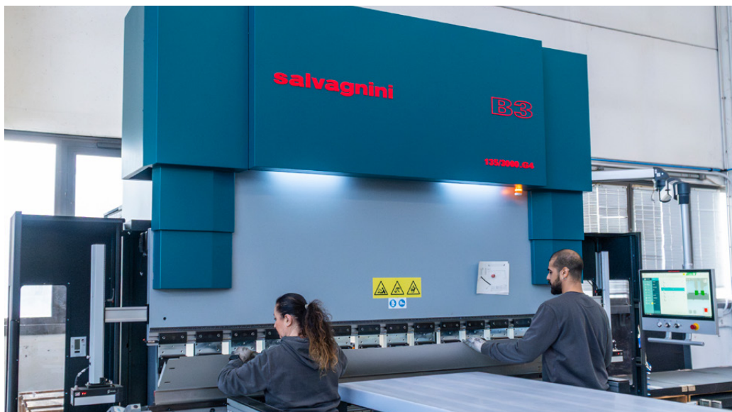
La sostituzione della precedente pressa piegatrice oleodinamica con una Salvagnini B3 135/3000 ha rappresentato per l'azienda bolognese il primo passaggio nella revisione della fase di piegatura
