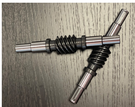
Vite senza fine z.4 m.1,75 rettificata post trattamento termico
