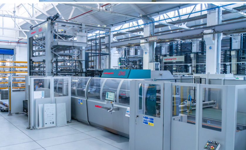
La nuova linea Salvagnini installata in Kone Industrial è composta da una punzonatrice S4 e una pannellatrice P4, alimentate da un magazzino a torre MD, con pressa piegatrice B3 integrata grazie al software P-PB-CXN
