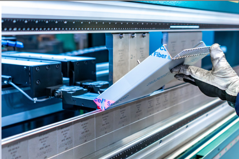
Il dispositivo brevettato di cambio utensili automatico superiore e inferiore AU-TO di Salvagnini riduce i tempi di allestimento e aumenta la disponibilità della pressa piegatrice
