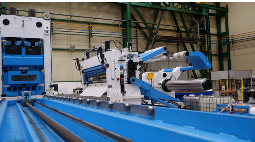
Aspo svolgitoro con sistema di introduzione, spianatrice e cambio rapido di bancata rulli
