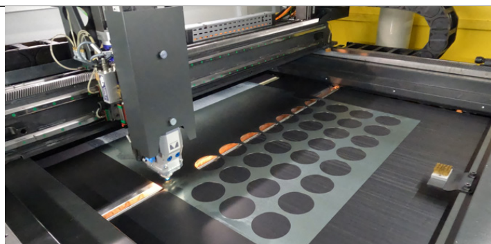
Torcia laser fibra con generatore di potenza a 6 kW
