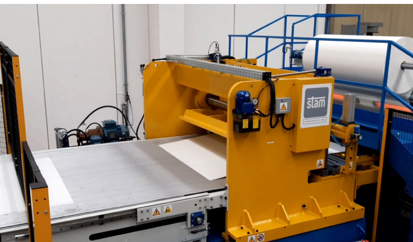
Il taglio a misura nella linea STAM avviene "al volo", mediante cesoia meccanica, a garanzia di massima efficienza e precisione
