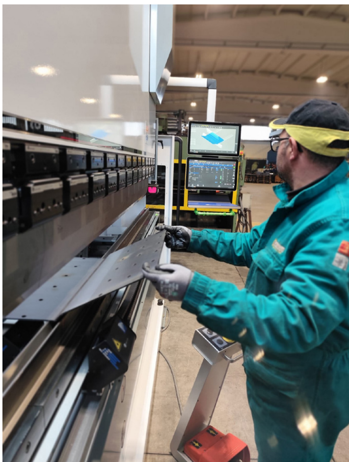
Dal punto di vista del controllo, la pressa piegatrice Vimercati modello PHSY ton 250 x 4175 mm, scelta da Metalcomp, è dotata del sistema ESA S875W 2D con doppio schermo
