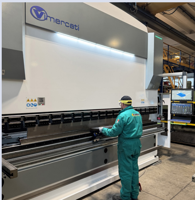
La nuova pressa piegatrice Vimercati assicura una forza fino a 250 ton con 4.175 mm di lunghezza libera di piega
