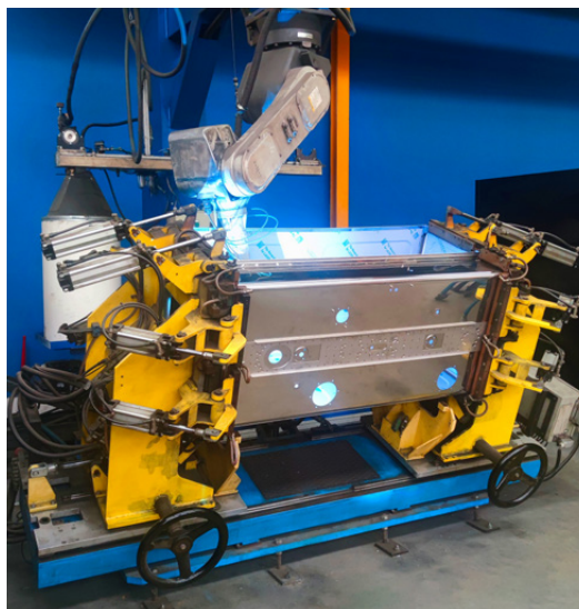
Saldatura MIG per forni industriali
