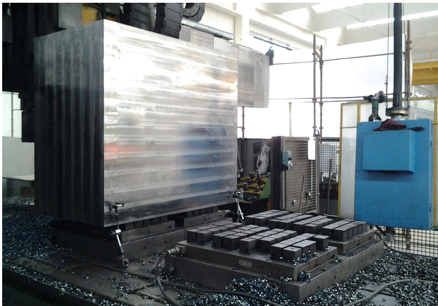
Applicazione dei piani magnetici SPD nelle lavorazioni di fresatura su pezzi forgiati di grandi dimensioni
