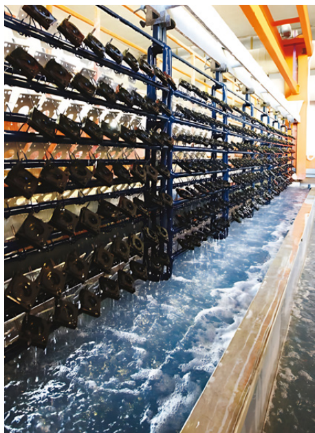
B.M. Group dispone di due impianti per i trattamenti, uno da 7.300 x 700 x 1.500 mm e uno da 4.000 x 700 x 2.500 mm
