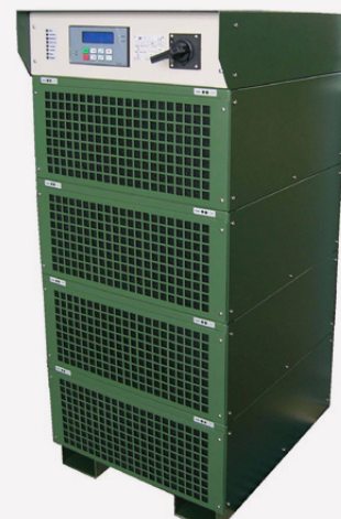
B.M. Group ha installato per l'elettrocolorazione un sistema R.C.V. modulare composto da 5 moduli di potenza ad alto rendimento energetico e 5 moduli di inversione di polarità modello Colortech AC/DC, per un totale di 1.500 A/25 V
