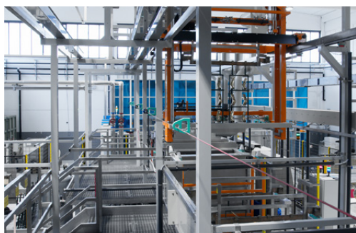
L'impianto realizzato da Caoduro Impianti in Palazzani prevede quattro stazioni per l'asservimento dell'impianto e una stazione specifica (in foto) per l'asservimento della zona di smetallizzazione dei telai
