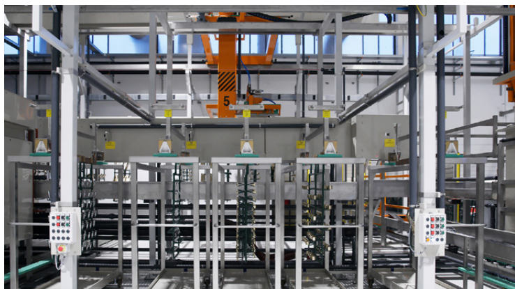
Composto da tredici stazioni di magazzino telai con gestione delle priorità, l'impianto realizzato da Caoduro Impianti in Palazzani si sviluppa su due linee, per un totale di 86 posizioni
