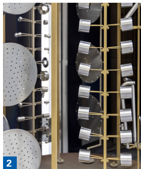
Figura 2. Grazie al nuovo impianto di lavaggio IFP Europe, Fima Carlo Frattini è in grado di trattare perfettamente i componenti da passare all’impianto PVD, introdotti in modo diretto senza che gli stessi vengano più manipolati adottabili
