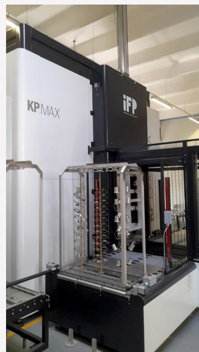
L'impianto KP 1300 MAX di IFP Europe scelto da Fima Carlo Frattini assicura il lavaggio di elementi di generose dimensioni, con cesti d'ingresso fino a 450 x 800 x 1.300 mm
