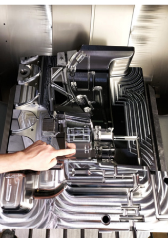
Esempio matrice stampo in acciaio 1.2343, 600 x 450 mm
