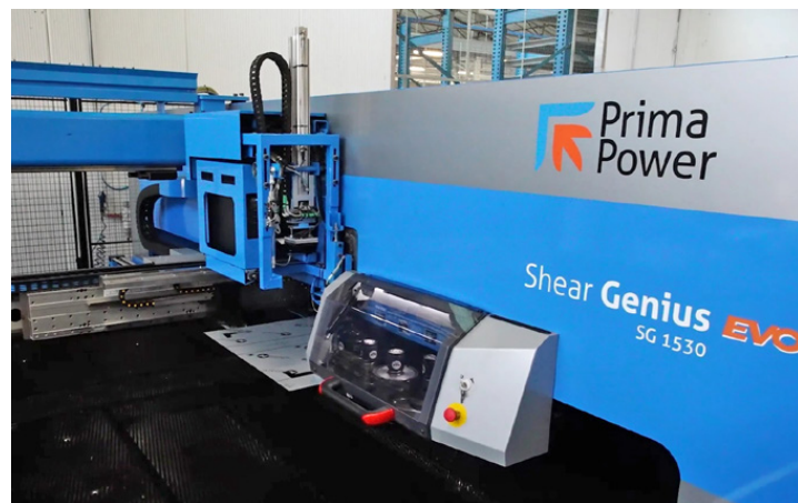
Tra le tecnologie Prima Power impiegate da Fhiaba spicca anche la cella di punzonatura e cesoiatura Shear Genius 1530, completa di soluzione di impilamento ad alta capacità STS (Sheared part Stacking System) e sistema di carico e scarico automatico LD (Loading System)
