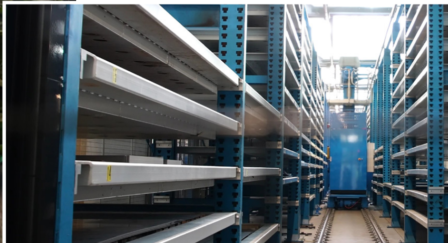
Produttività e flessibilità di processo sono potenziate in Fhiaba dalla presenza di un Night Train Genius, soluzione di immagazzinaggio automatizzata sempre progettata e realizzata da Prima Power
