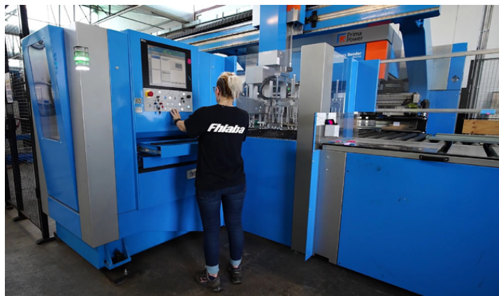
Le macchine presenti in Fhiaba, come la Express Bender, sono unite in una linea di produzione flessibile, a sua volta collegata al Night Train FMS, offrendo grande versatilità operativa
