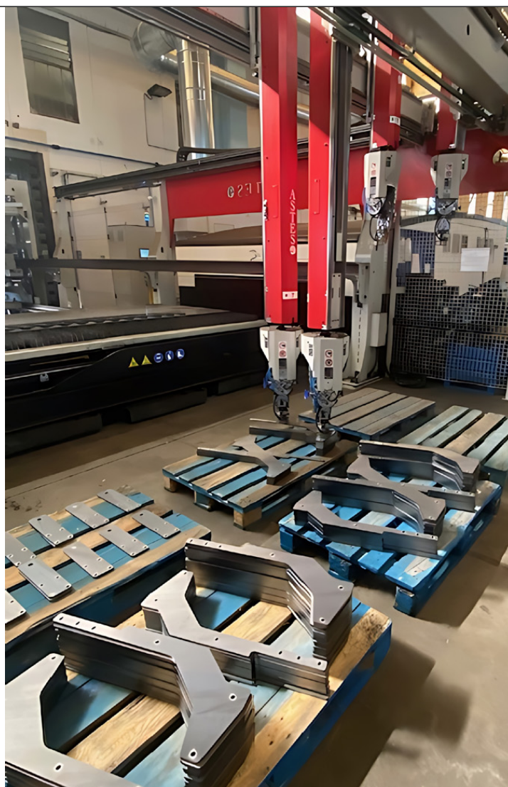
Le 4 teste indipendenti del sistema SortPro 4020 di Astes4 assicurano anche a Nuova Sider elevata flessibilità ed efficienza operativa nella gestione dei pezzi tagliati
