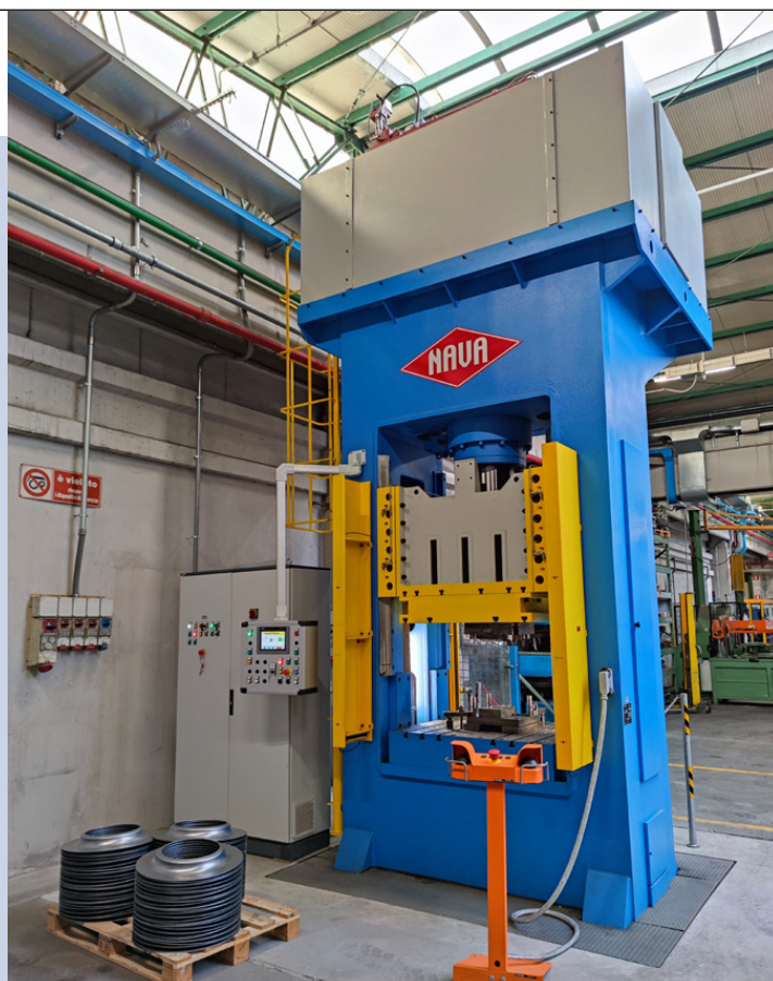
Pressa 2MI 250/125 della F.lli Nava installata da Comefri nel proprio reparto di stampaggio negli stabilimenti di Magnano in Riviera (UD)
