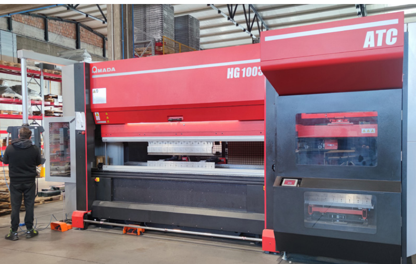
Tra le ultime macchine Amada installate in Siver figura anche una piegatrice HG-1003 ATC ad attrezzaggio automatico
