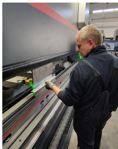
La nuova pressa piegatrice Bystronic Xpert Pro 250/4300 Extended assicura a Porfiri precisione sin dal primo pezzo, grazie alla presenza di utili funzioni intelligenti di assistenza come il generatore di curve nel materiale e il sistema di misura dell'angolo
