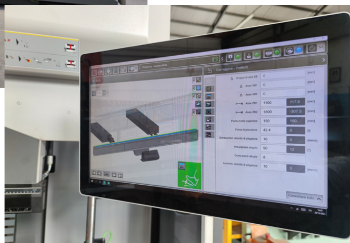
La nuova pressa piegatrice Bystronic Xpert Pro 250/4300 Extended assicura a Porfiri precisione sin dal primo pezzo, grazie alla presenza di utili funzioni intelligenti di assistenza come il generatore di curve nel materiale e il sistema di misura dell'angolo
