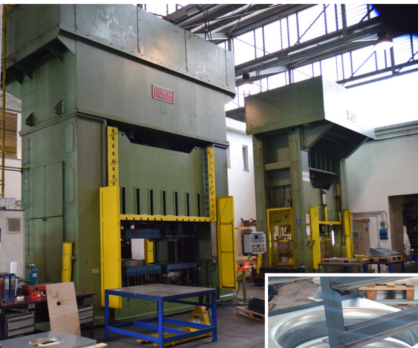
Presso la propria sede produttiva di Lurano (BG), STL si avvale, oltre alla nuova installata da 250 ton, anche di 2 presse sempre della F.Ili Nava da 500 e 700 ton
