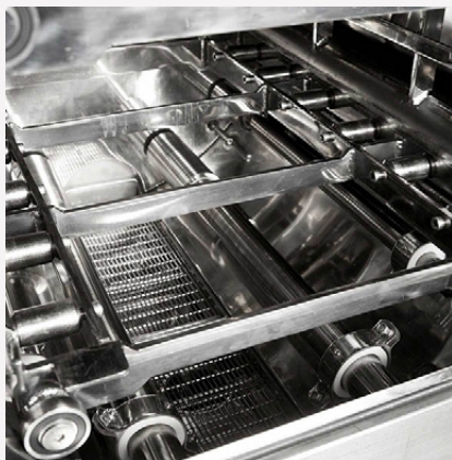
La tecnologia di lavaggio a ultrasuoni degli impianti IFP Europe risulta molto efficace anche nella pulizia di pezzi di precisione da tornitura come quelli realizzati da Eredi Baitelli
