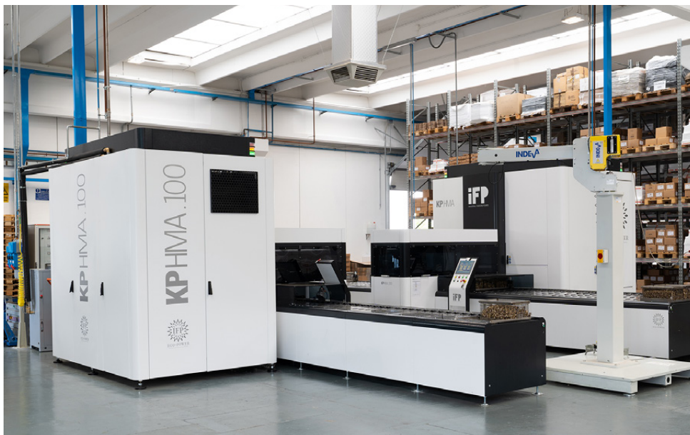
Eredi Baitelli ha potenziato la fase di lavaggio affiancando, lo scorso anno, alla KP 200 HMA, una nuova KP 100 HMA; anch'essa, 4.0 ready, utilizza alcoli modificati, ultrasuoni e il trattamento sottovuoto per coniugare elevati carichi di lavoro e completa decontaminazione del pezzo
