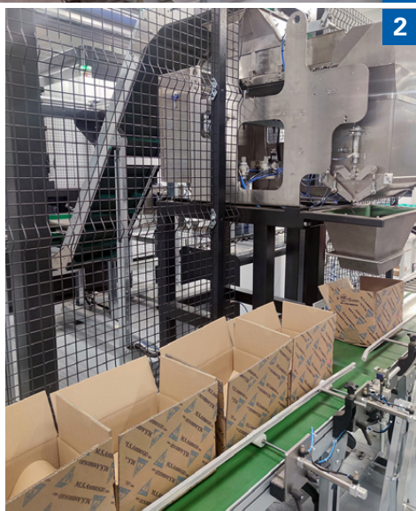
Figura 1-2 Uno dei due impianti IFP Europe KPHMA 400 è stato allestito in M.S. Ambrogio Group anche con un sistema a fine linea di confezionamento automatico dei pezzi già lavati e asciugati, pronti per la consegna
