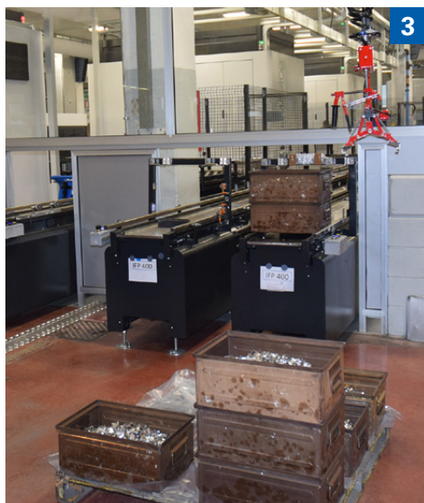
Figura 3 Dettaglio del punto d'ingresso unico dove vengono posizionati i cestelli coi pezzi da lavare, poi smistati sulle macchine a seconda del carico pianificato Figura 4 M.S. Ambrogio Group è in grado di produrre anche componenti tranciati e piegati da nastro - Figura 5 Ing. Ivan Meoni, Manufacturing Director di M.S. Ambrogio di Cisano Bergamasco (BG) - Figura 6 Ing. Valerio Pirovano, Production Manager Plant 2 di M.S. Ambrogio di Cisano Bergamasco (BG) - Figura 7 La rapidità di ciclo assicurata dagli impianti IFP Europe permettono alla M.S. Ambrogio Group di ottimizzare ridurre in modo significativo il lead-time - Figura 8 Punto di ritiro cestelli a fine ciclo
