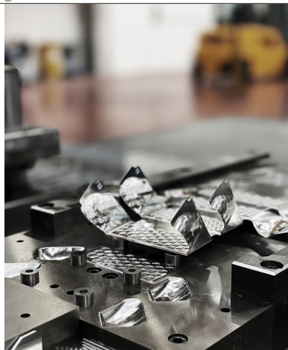
Dettaglio stampo trancia passo del sistema ottico Pentha
