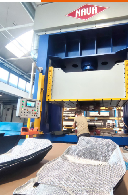
In primo piano, isolamento termico con superficie riflettente
