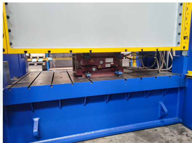
La pressa 2MS 250 della F.lli Nava si caratterizza anche per la forza della mazza regolabile fino a 2.500 kN e piano di lavoro da 2.500 x 1.400 mm
