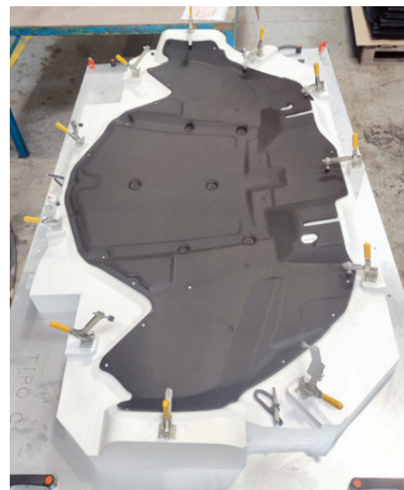
Isolamento sottocofano per nuova vettura, stampato e posizionato su calibro di controllo
