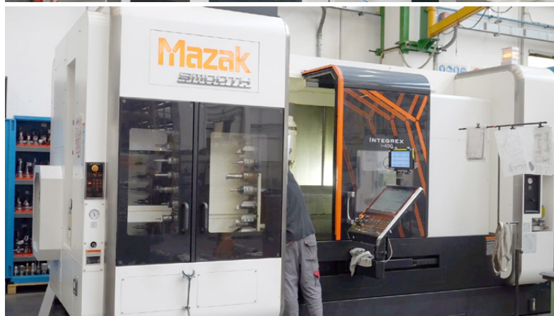
Tra le tecnologie Mazak presenti in C.R. anche un centro di lavoro multi-tasking Integrex i-400 5 assi in continuo, dotato di controllo Mazatrol SmoothX
