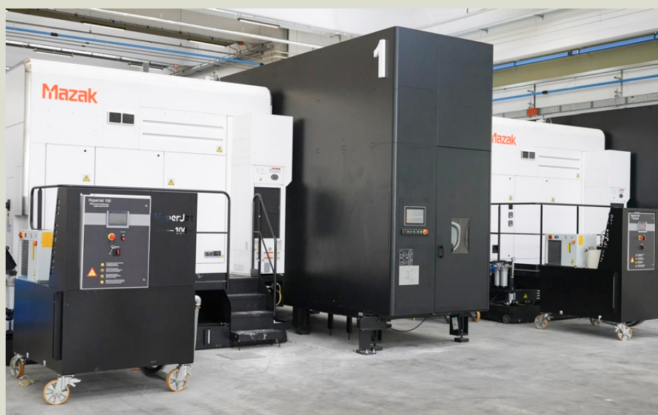
Tra le ultime macchine Mazak installate ci sono le due nuove stazioni multi-tasking Vortex i-800V/8, collegate al sistema di automazione Pallettech a due livelli
