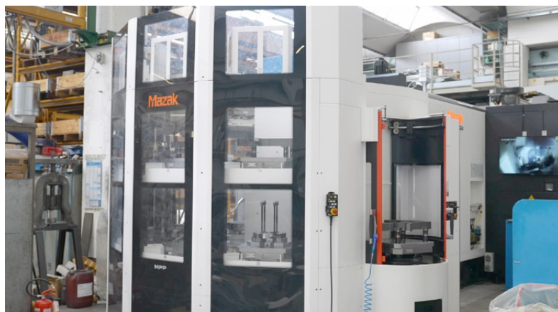
Dettaglio centro di lavoro Mazak VARIAXIS i-700 5 assi in continuo, completo di Multipallet MPP 18 stazioni, entrambi gestiti dal controllo Mazatrol SmoothX
