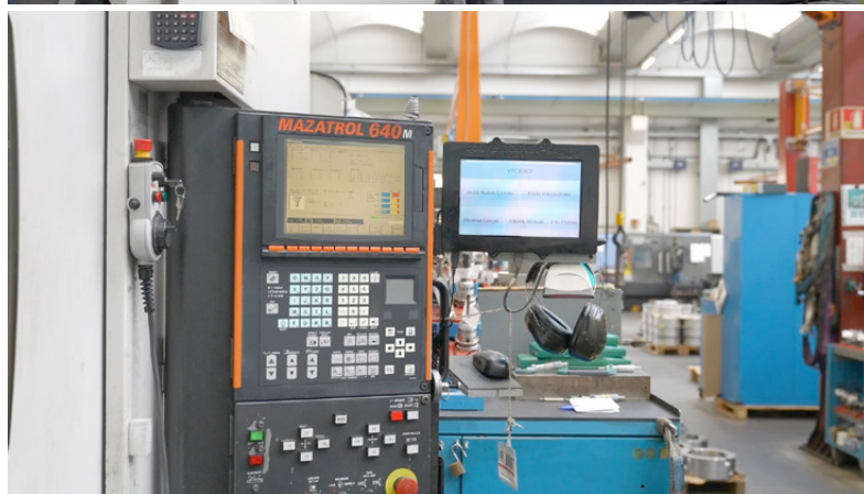
Anche in C.R. il linguaggio di programmazione Mazatrol di Mazak permette di abbattere i tempi di programmazione a bordo macchina
