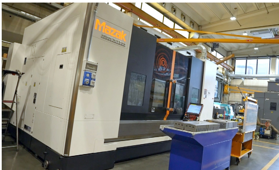
Centro di lavoro verticale a 5 assi Mazak VTC 800-30 SR, con tavola opzionale in continuo, a testa tiltante, nel reparto di fresatura della Fratelli Magro
