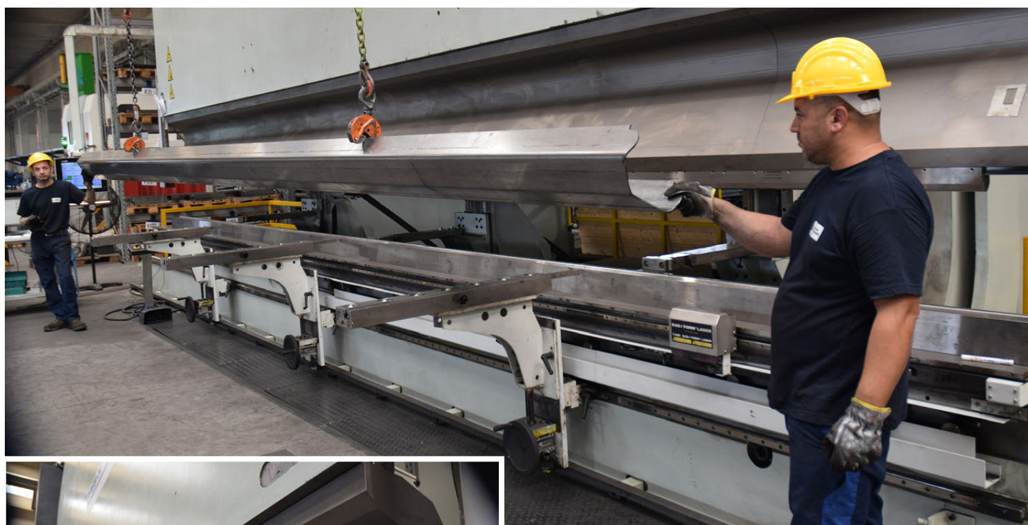
Il nuovo utensile realizzato da Tecnolame permette alla Acciai di Qualità di realizzare profili ad alto spessore di grandi dimensioni di elevata precisione e qualità
