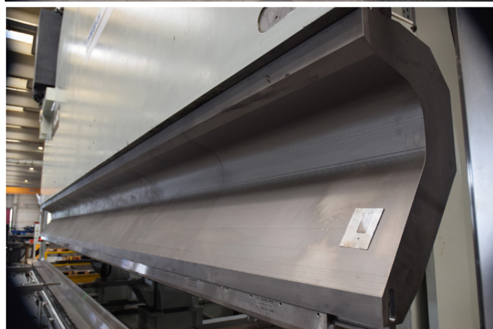
Realizzato dal pieno da Tecnolame, il particolare utensile è stato costruito come fosse un pezzo unico, per una lunghezza complessiva di 9.180 mm, sezionato in 9 elementi da 1.030 mm ciascuno
