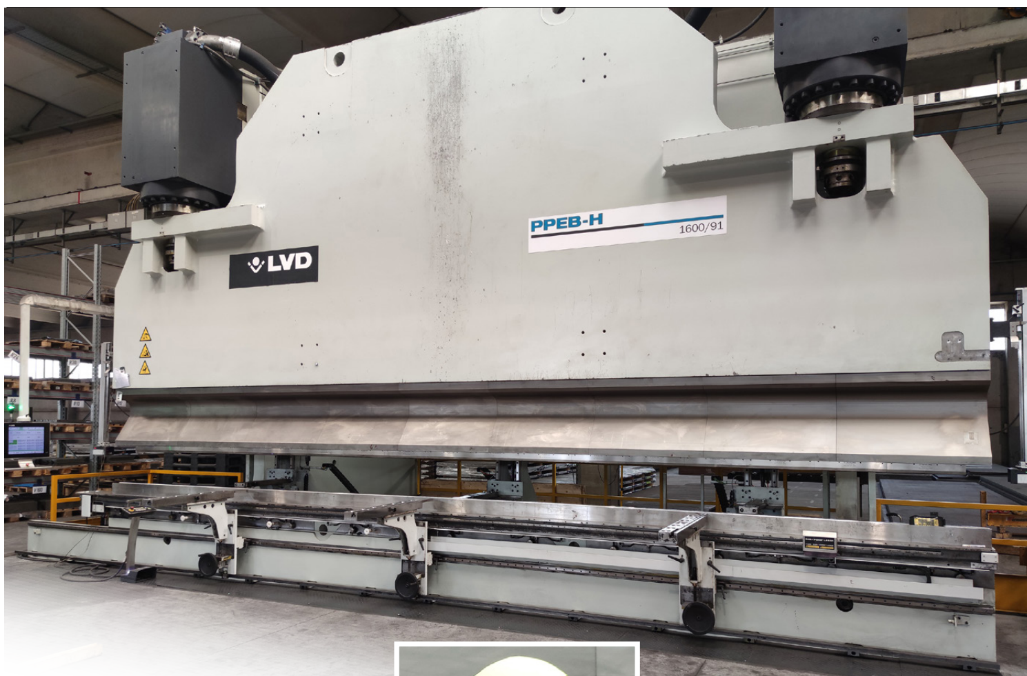
Dettaglio della nuova pressa piegatrice LVD da 1.600 ton su 9.000 mm, dotata dell'imponente utensile realizzato per Acciai di Qualità da Tecnomame
