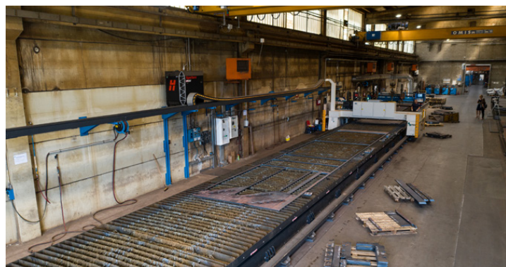
Linea automatica gantry a CNC Kronos KR32SP di Ficep
