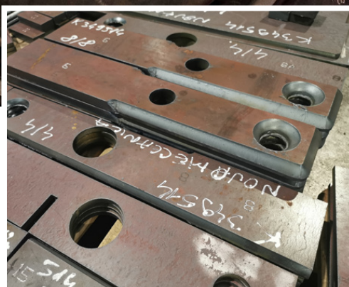
Pezzi realizzati con la testa bevel installata sulla linea KR32SP
