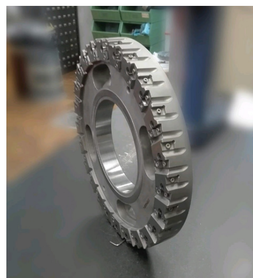
Fresa Ø300 per sgrossatura con 48 inserti, con elementi di regolazione per gli inserti di finitura, realizzata da UT.MEC. e utilizzata per lavorazioni di componenti in ghisa
