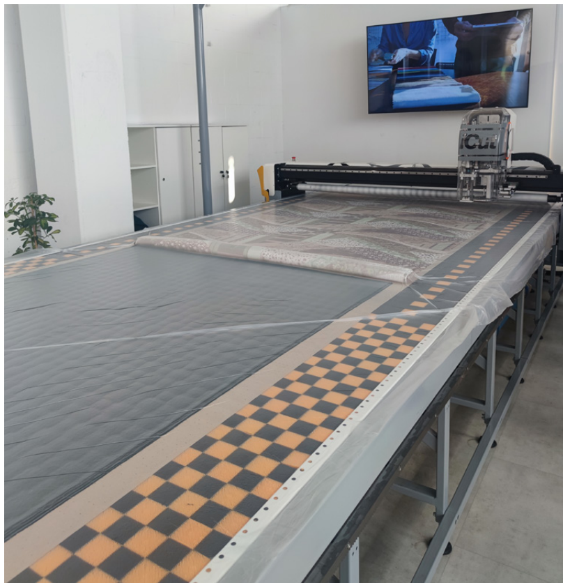
Tailor di Orox Group è una soluzione di taglio automatico statico che permette di unire la produzione in continuo e il monotelato, assicurando massima versatilità operativa
