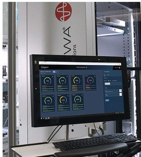
Erowa JMS 4.0 - sul Dashboard OEE si riconosce immediatamente il livello di efficienza dell'impianto nel suo complesso e in dettaglio per ogni singola macchina
