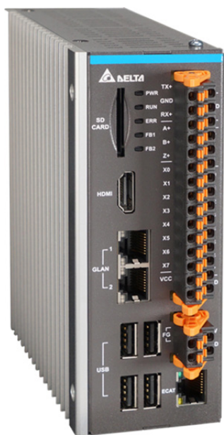
La nuova generazione di motion controller serie AX-8 di Delta Electronics, basata su Pc, utilizza l'ambiente di sviluppo Codesys
