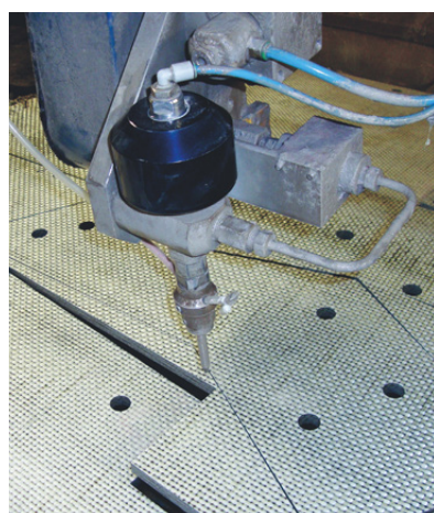
Elet.Ca dispone al proprio interno anche di tecnologia di taglio water jet a 5 assi
