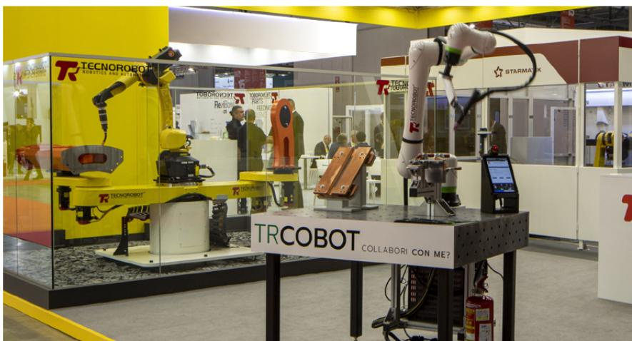
In primo piano l'impianto con robot collaborativo per saldatura TIG; sullo sfondo l'impianto robotizzato per saldatura MIG/MAG con posizionatore a 4 gradi di libertà, completo di cambio stazione. Entrambi sono stati realizzati da Tecnorobot con robot Fanuc
