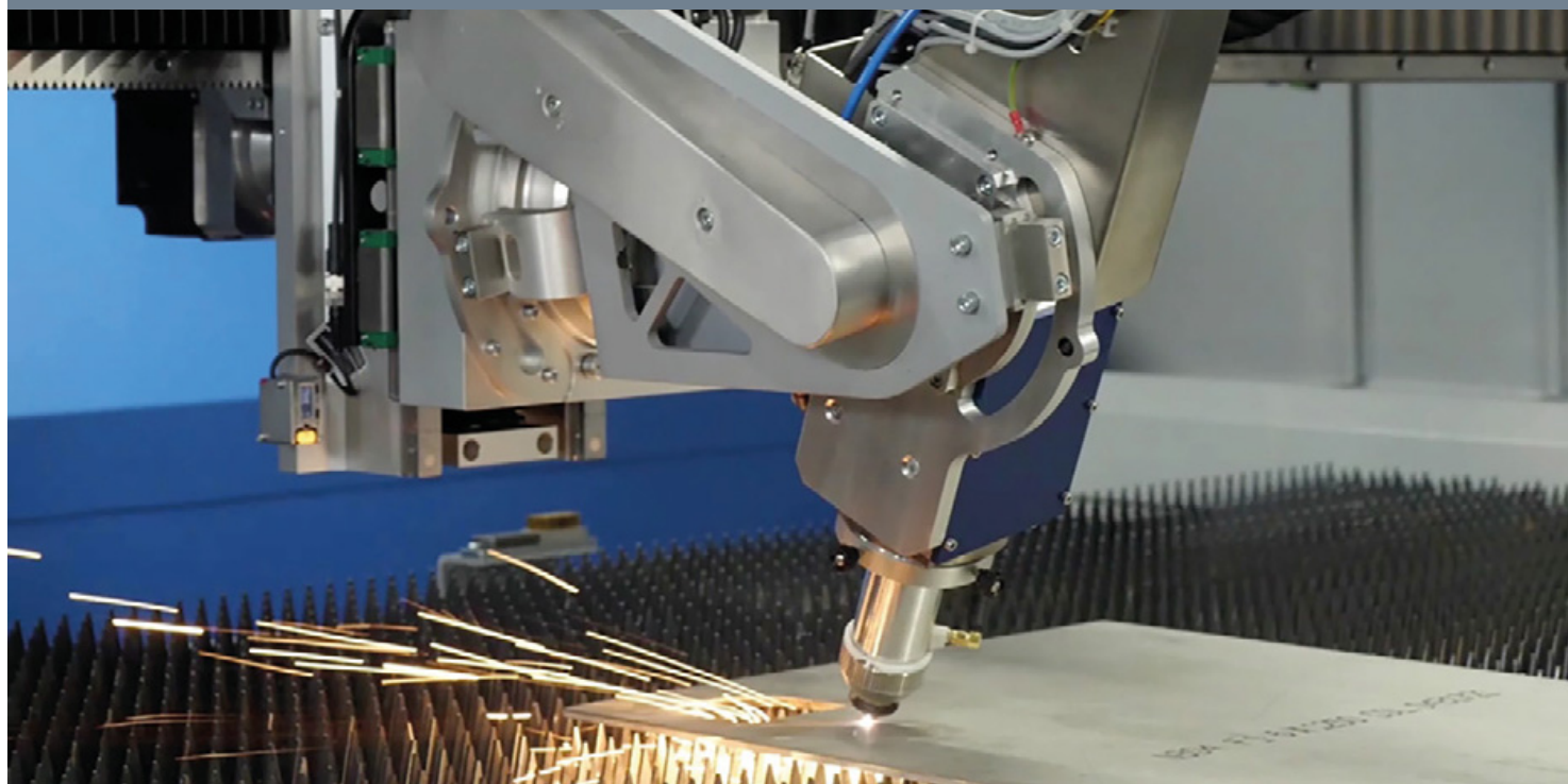
Dotato di testa Bevel con cianfrino variabile, l'impianto di taglio laser Cy-laser CY2D HL 8030 consente a CEAP di effettuare complesse lavorazioni di taglio inclinato
