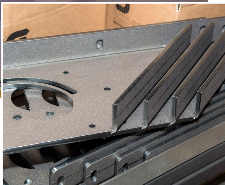
Particolari in acciaio tagliati da Ense con gli impianti Tecoi e poi piegati
