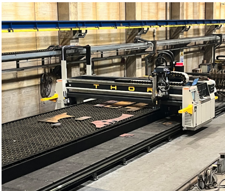
Con banco di lavorazione da 3.500 x 24.000 mm, testa bevel al plasma combinata con un ossitaglio, il nuovo impianto Thor di Tecoi ha rappresentato per Ense un importante salto di qualità in termini di maggiore competitività globale
