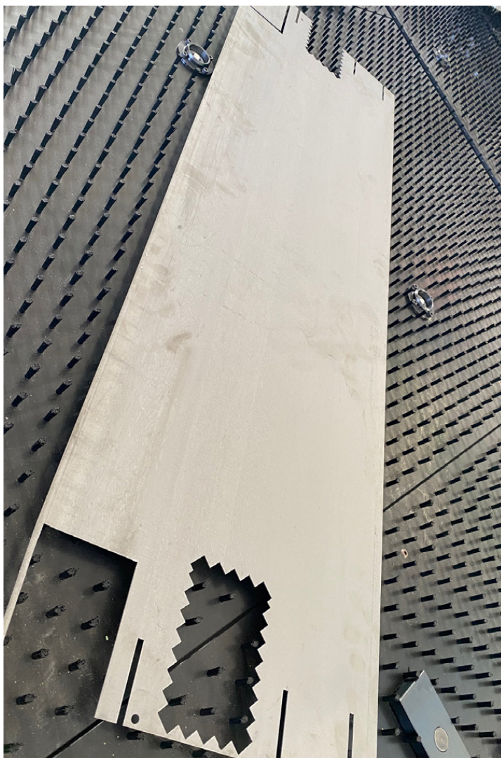
Lamiera nera spessore 1,5 mm per case porta Cpu
