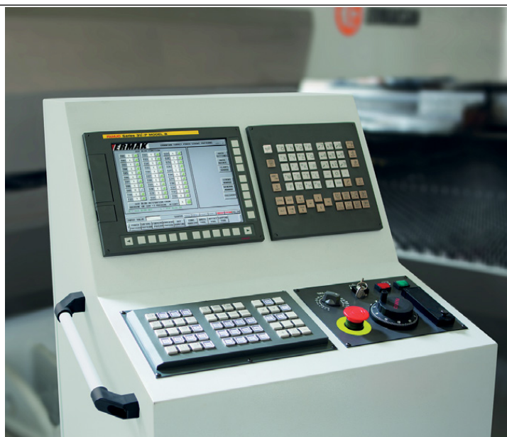
La punzonatrice a torretta elettrica Ermaksan mod. Servo-ETP 25.30 possiede un pannello di controllo separato con CNC Fanuc e pedale utile all'operatore durante il carico delle lamiere
