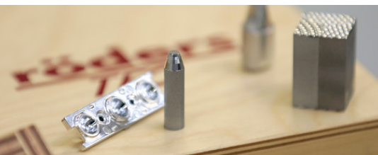
Alcuni esempi di particolari ottici realizzati con la fresatrice Röders RXP 501 Z2 (ph. Archivio iGuzzini)
