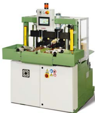
Le garbatrici Comec mod. SPM/15 sono ideali per garbare ogni tipo di sottopiede in qualsiasi materiale
