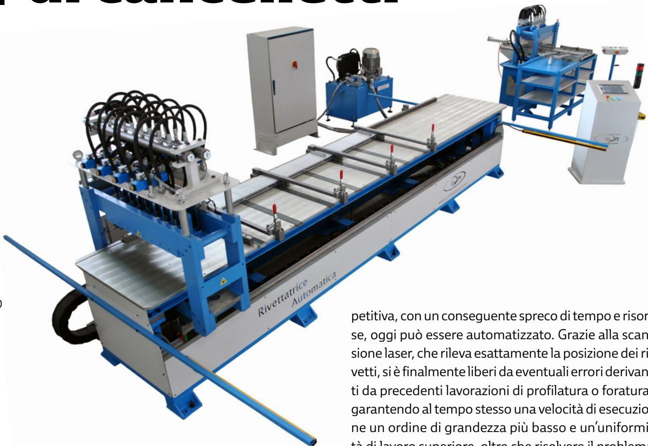
**S**pecializzata nella progettazione e nella produzione di linee complete di punzonatura, impianti automatici e isole robotizzate per la lavorazione di lamiere e profili metallici di alta qualità, oPm ha realizzato un innovativo impianto per l'assemblaggio di cancelletti metallici estensibili. Stiamo parlando di un impianto in grado di rilevare attraverso una precisa scansione laser e poi rivettare automaticamente i rivetti di fissaggio dei cancelletti metallici per sicurezza perimetrale.
