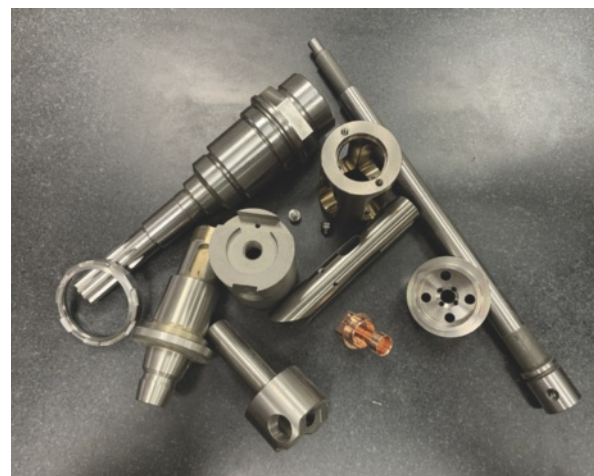
I componenti realizzati da Telemeccanica possono raggiungere diametri massimi sino a 300 mm e sono destinati a svariati settori.
