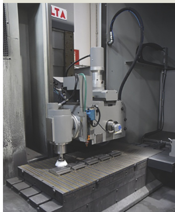
Particolare della testa porta-mola e del mandrino verticale che permette di eseguire lavorazioni molto particolari
