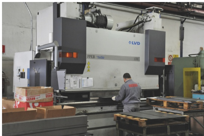
Oltre a due pressepiegatrici Lvd asservite da robot, Rosss beneficia di un'ulteriore macchina del costruttore belga; postazione manuale orientata alla preparazione di pezzi speciali
