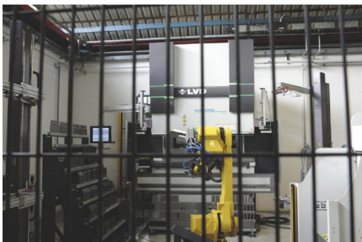
Rosss ha recentemente inserito nel proprio reparto di piegatura una isola robotizzata con una nuova pressopiegatrice Lvd PPEB-EFL 80/20
