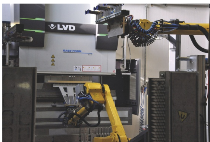
La pressopiegatrice Lvd PPEB-EFL 80/20 è integrata in un'isola di lavoro con cambio utensile e con cambio gripper eseguiti da due robot
