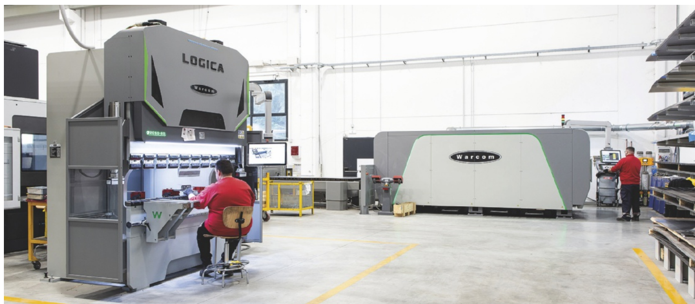
Vista nuovo reparto lavorazione lamiere di BT Group con impianto di taglio laser W-Fiber e pressa piegatrice elettrica Logica Warcom
