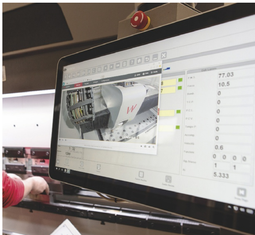
Con il sistema di monitoraggio diretto W-View dell'impianto di taglio laser W-Fiber che prevede al suo interno una telecamera ID a raggi infrarossi, l'operatore impegnato alla piegatrice può verificare direttamente dal monitor lo stato di avanzamento del taglio
