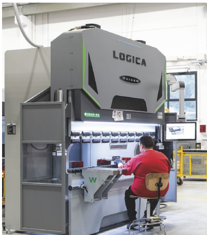
Precisa efficiente e silenziosa, la pressa piegatrice elettrica Warcom Logica 2050-80 assicura una forza massima di 80 ton con lunghezza utile di piega fino a 2.050 mm
