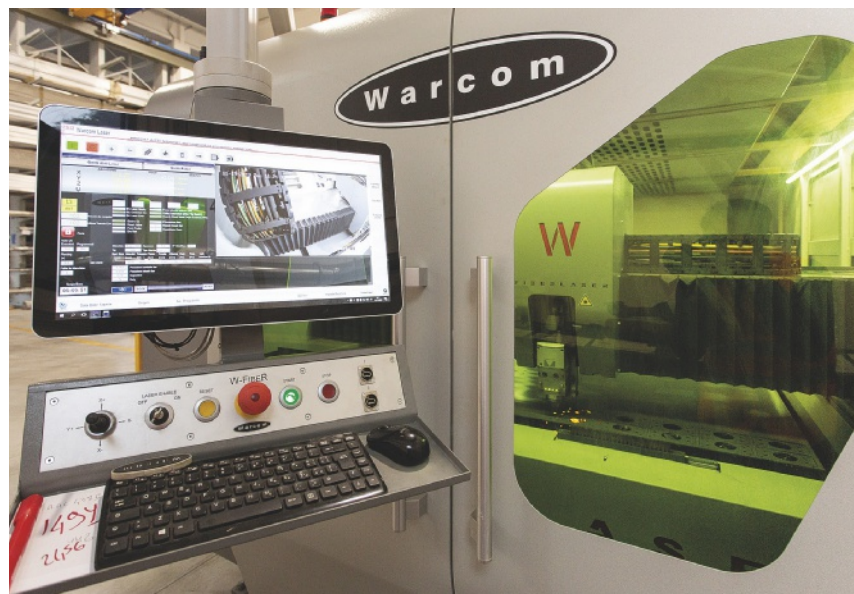
L'impianto di taglio laser Warcom W-Fiber 15-30 con sorgente da 3 kW scelto da BT Group consente di lavorare diversi materiali, inclusi quelli altamente riflettenti, su un'area massima di lavoro di 1.500 x 3.000 mm
