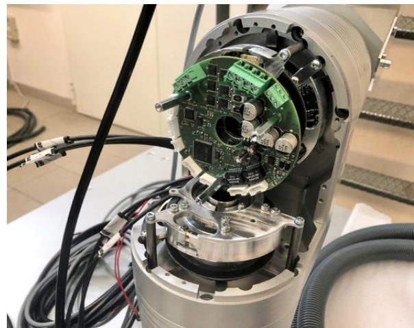
Compatti e performanti, i giunti robotici J-Actuators si distinguono per le elevate prestazioni cinematiche, di precisione, ed anche per l'innovativa elettronica di bordo su bus EtherCat, comprensiva di ben 3 livelli di sicurezza.
